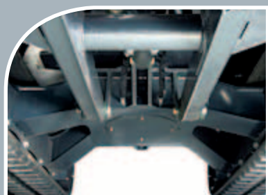
Il nuovo sottocarro a "X" aumenta l'altezza minima da terra e favorisce il distacco dei detriti eventualmente accumulatisi.
